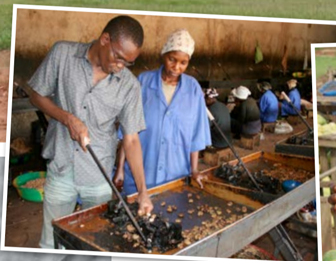
Mamadou Traore – Ingenieur für ländliche Entwicklung – zeigt die Knackmaschine, mit der die Frauen die harte Schale jeder einzelnen Cashewnuss aufbrechen.
